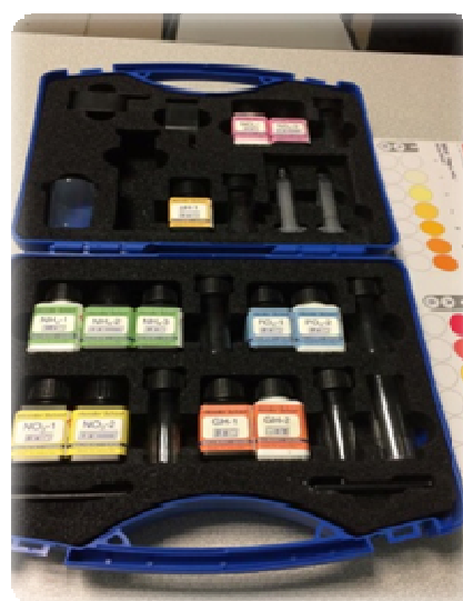
Malette d'analyse de la qualité physico-chimique de l'eau utilisée pour les analyses complémentaires
